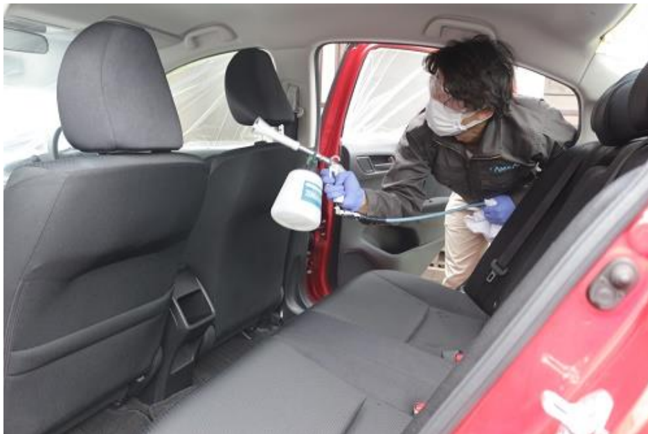
抗ウイルス抗菌コーティング(「レコナガード エアフレッシュ」) 教習車内の施工の様子
